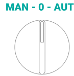
Mise à l'arrêt
